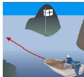
No balizamento de uma hidrovia, ao observar-se um sinal “▣” numa placa no rio, significa seguir margem.
