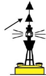
O sistema de balizamento poderá ser de um dispositivo chamado Racon que é um sistema que emite um sinal na tela do radar e que facilita, portanto, a sua identificação.
