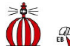
Indicam águas navegáveis em torno do sinal ; incluem sinais de linha de centro, e sinais de meio de canal. Tal sinal pode também ser usado como alternativa para um cardinal ou lateral indicar uma aproximação de terra. Quando luminosa, a bóia exibe luz branca isofásica ou de ocultação ou de lampejo longo a cada 10 segundos ou em código Morse exibindo a letra "A".
