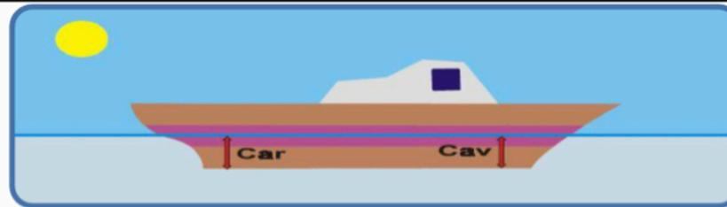
Embarcação TRIMADA: o Calado a vante é igual ao Calado a ré ( $Cav = Car$ ).
